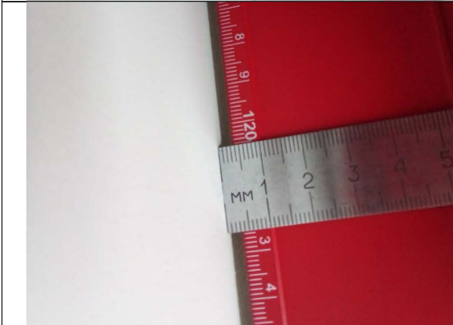
Фото № 14. Измерение отклонения от вертикали стены в кухне-столовой.
